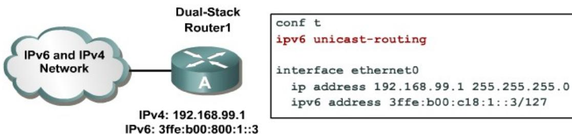
Nutzen Sie die Vorgaben in der Abbildung. Der Router erhält jeweils die erste und die beiden Arbeitsplätze die zweite und dritte IP-Adresse. Testen Sie die Verbindung mit <ping>.
